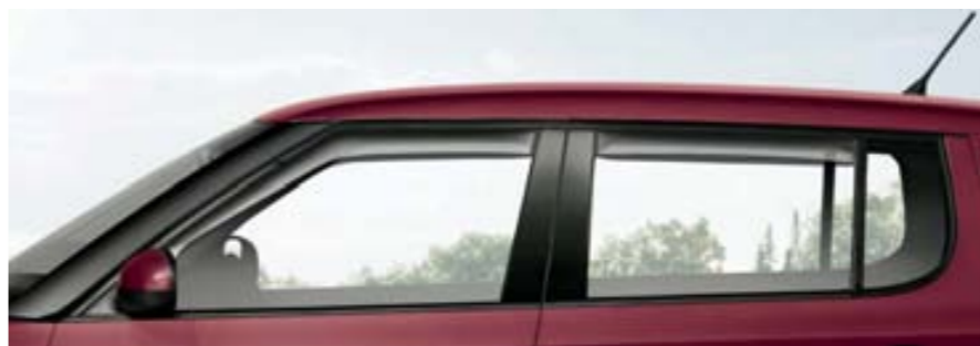
Větrné clony bočních oken (KCD 709 001 – pro přední okna, KCD 719 001 – pro zadní okna Fabia Hatchback, KCD 729 001 – pro zadní okna Fabia Combi)
